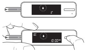
Lorsque le " & " apparaît sur l'écran d'affichage, appuyez sur le bouton principal et "QC" (contrôle) apparaît sur l'écran. Lorsque "QC" est affiché, le lecteur ne mémorise pas le résultat du test. Si vous ne souhaitez pas procéder à un test avec solution de contrôle, appuyez une nouvelle fois sur le bouton principal et "QC" disparaîtra de l'écran.
